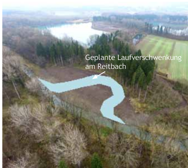
Nach der Rodung der Fichten wird die Fläche abgesenkt und der Lauf des Reitbachs verschwenkt. Abschließend wird die Fläche wieder mit typischen Auwald-Bäumen bepflanzt.
